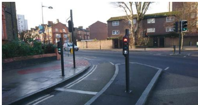
Slika 3. Odvajanje biciklističkog saobraćaja od saobraćaja motornih vozila primenom semafora.
