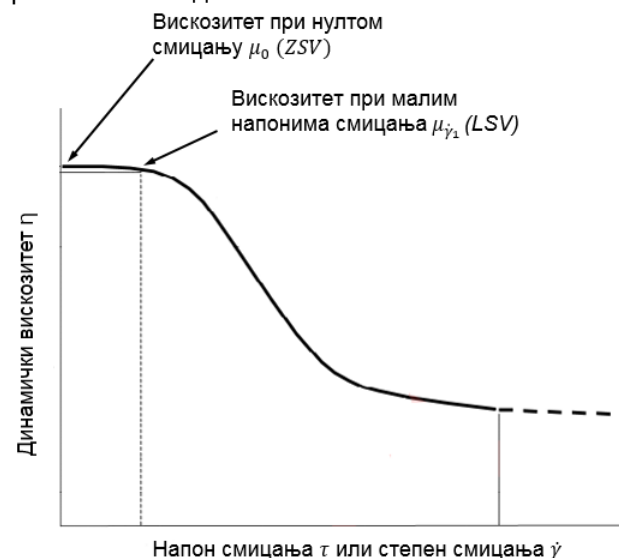
Слика 1. Дефиниција параметара LSV и ZSV , прилагођено из [9]
