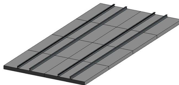
Слика 4. Конфигурација бетонских плоча и трамвајских колосека
