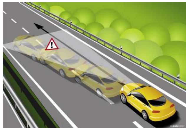
Slika 1. Sistem za podršku obezbeđenja zadržavanja vozila u saobraćajnoj traci (LSS)
