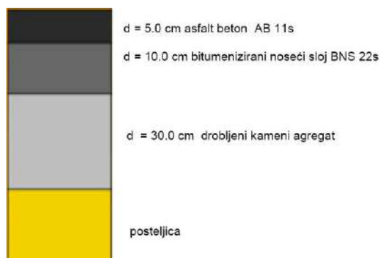
Slika 5. Usvojena kolovozna konstrukcija [2]
