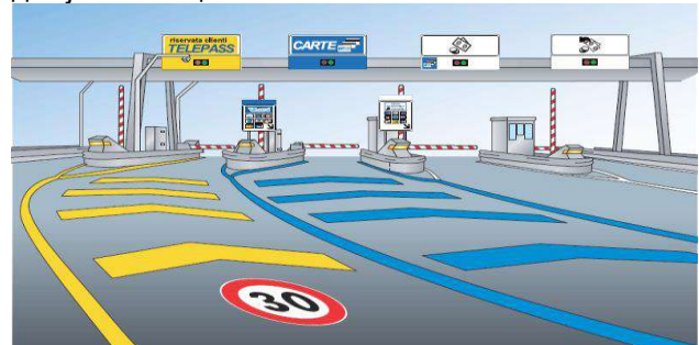
Слика 8: Изглед ETC / DSRC систем наплате путарине са баријерама у Италији (Извор: Spea Ingegneria Europea S.p.A.)
