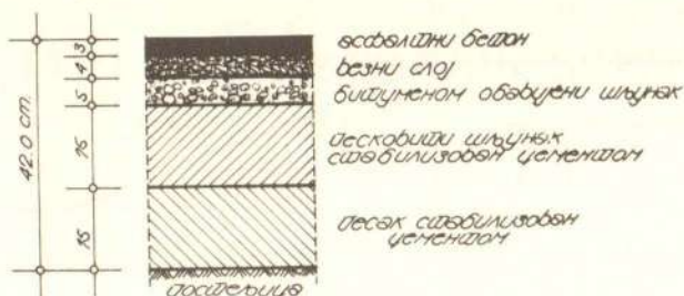
Сл. 4 — Пресек коловозне конструкције, варијанта (А)
