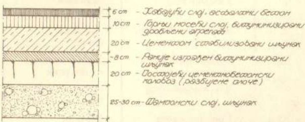
Сл. 1 — Пројектована коловозна конструкција леве коловозне траке на деоници Појиници—граница САП Војводине
