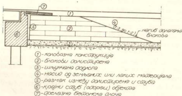
Сл. 2. Подужни пресек прилазног насипа (навоза) од врло лаког материјала ка објекту.
