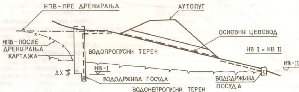
Сл. 4. Систем одводњавања терена помоћу сифона
