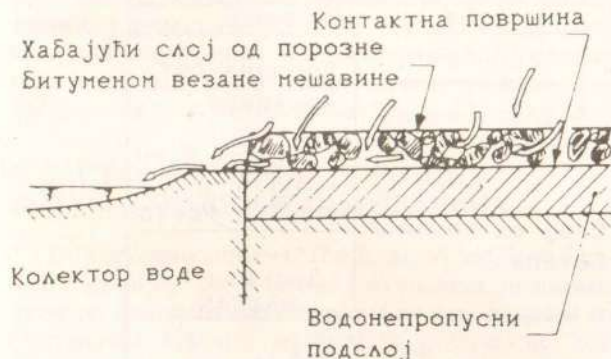
Сл. 1 – Пример коловозне конструкције са порозним битуменом везаном мешавином [3]
