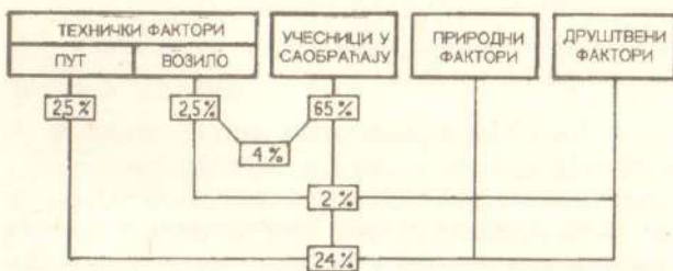
Слика 1 – Упростићен приказ квантификације и узајамног дејства појединих група фактора на настајање саобраћајних незгода
