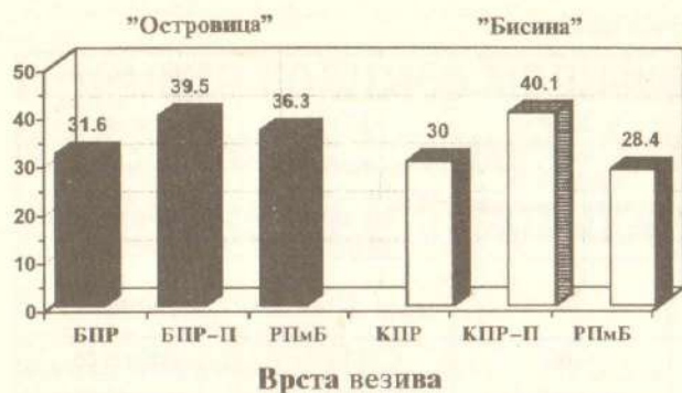
Слика 1 – Маршалови модули на 40^{\circ}\text{C} за асфалтне мешавине по хладном поступку са различитим каменним агрегатом и емулзијама разређеног везива
